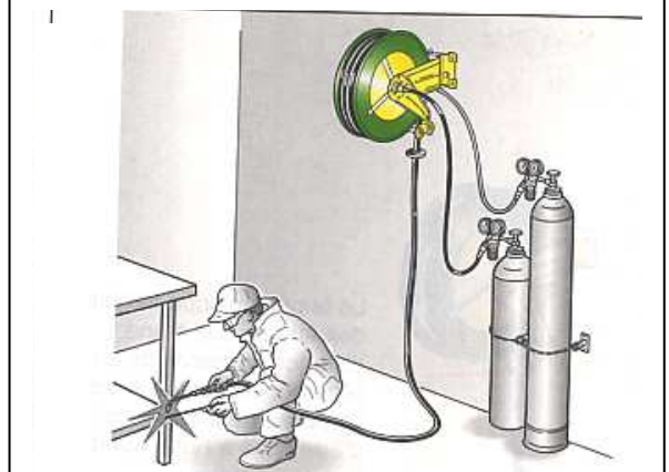
Enrouleur fixé au mur pour l'utilisation d'un Chalumeau
